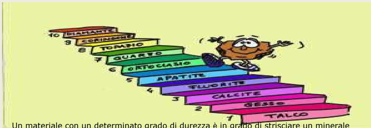
Un materiale con un determinato grado di durezza è in grado di strisciare un minerale caratterizzato da un numero più basso. Per esempio un'unghia, che ha durezza 2, può scalfire un campione di talco che ha solo 1; un pezzo di vetro rotto, che ha durezza 5, può strisciare la calcite (3) oppure la fluorite (4). Un diamante (10) è talmente duro che può tagliare un vetro di una finestra come un coltello taglia il burro!
